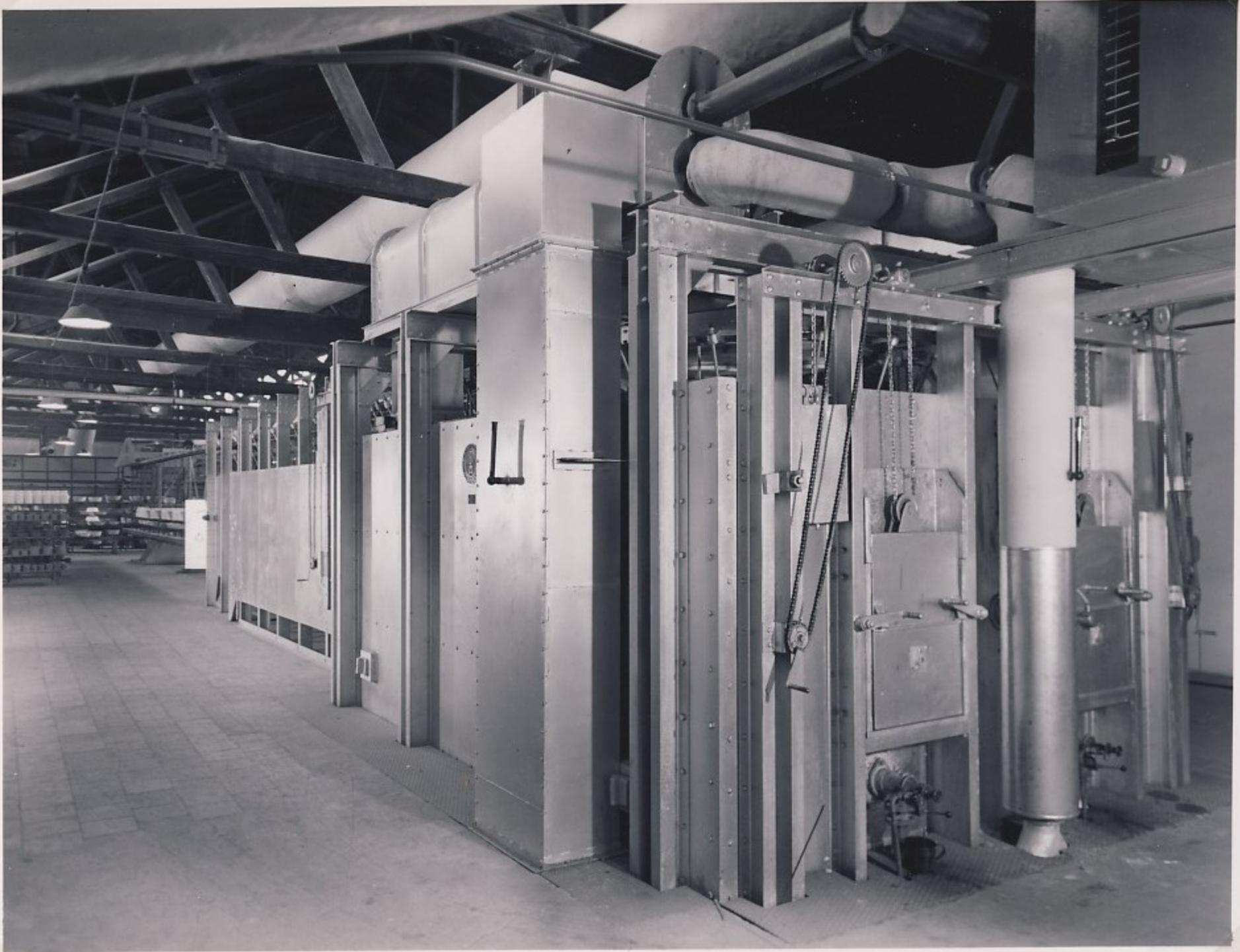
Die fertig aufgetragenen und getrockneten Geschirre werden auf die insgesamt 36 Hängeroste aufgelegt oder aufgehängt und wandern mit diesen in den Ofen. Sie passieren hier zunächst eine Vorwärmzone, dann die eigentliche Brennzzone, in der auch die Umkehr der Hängeroste erfolgt und verlassen, nachdem sie eine Abkühlzone durchlaufen haben, fertig den Ofen. Die Abgase des Ofens beheizen die Trockenanlage.
